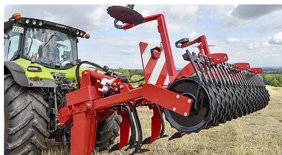
△ Die Randscheiben lassen sich hydraulisch klappen. Die Abstreifer an der Zahnring-Packerwalze sind für einen besseren Krümmeleffekt etwas höher montiert.
