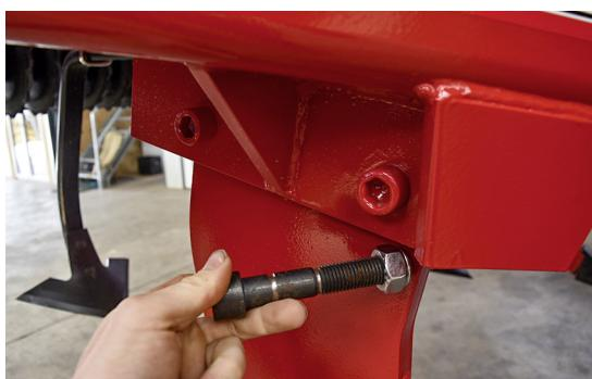
△ Bis auf die eingedrehten Sollbruchstellen gleichen die Scherschrauben der zweiten Schraube.
